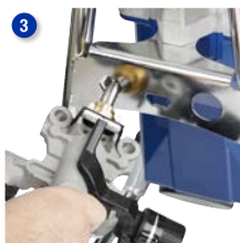
3 Bruk sekskantbeslaget til å løsne og fjerne pumpen
